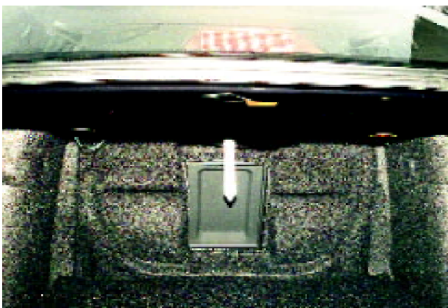
Abb. 4 Weber-Isis-Universal-Aktivator Montage im Kofferraum
